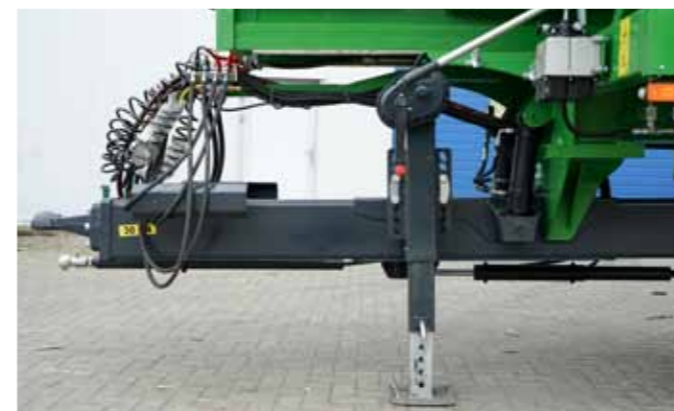
Dyszel uniwersalny sztywny amortyzowany hydraulicznie
