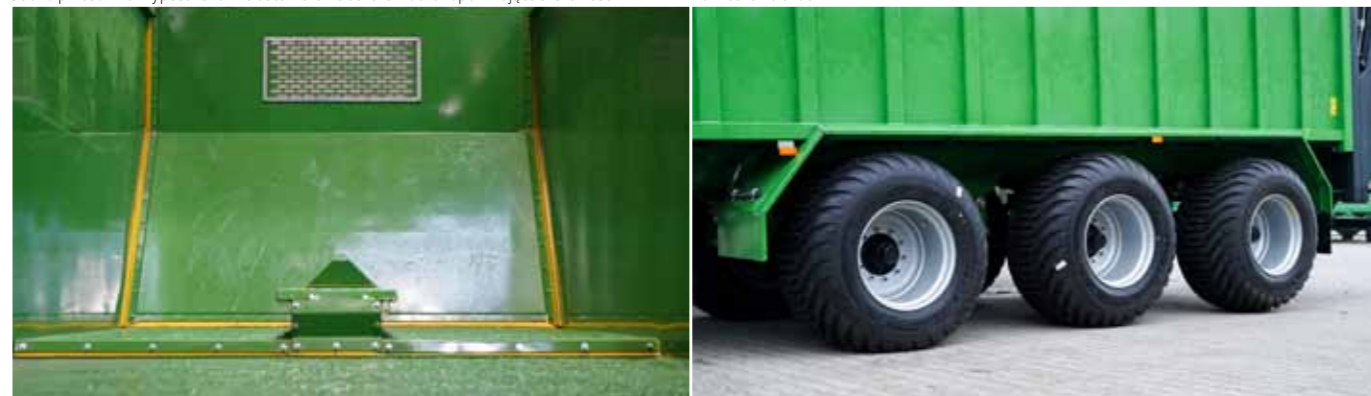
Ściana przesuwna wyposażona w elastomerowe uszczelniacze zapewniające szczelność
