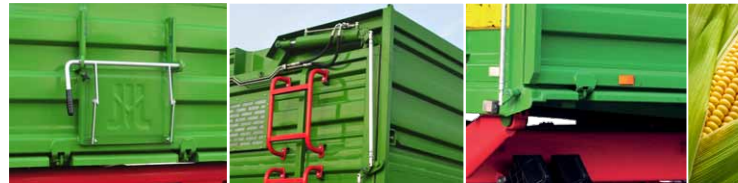
Szyber zsypany do ziarna, z blokadą, w ścianie tylnej
