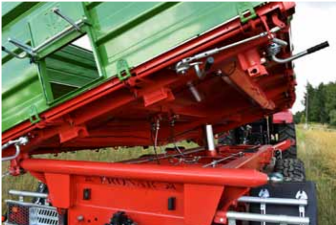
System wyrotu trzysstronnego z przegubami kulowymi tylnymi amortyzowanymi
