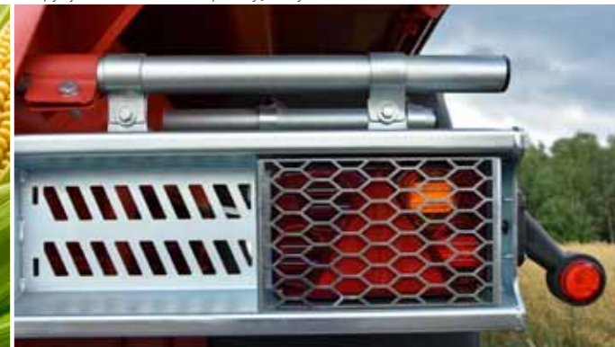
Lampy tylne LED, kratki zabezpieczające szybkodemontowalne
