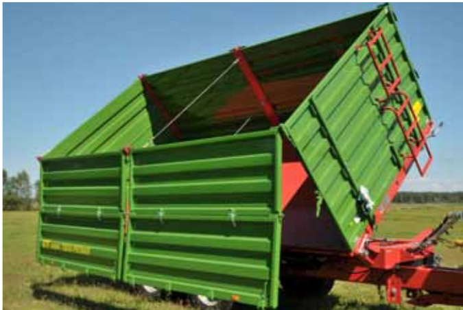
Skrzynia ładunkowa z uniwersalnym, wahadłowym, systemem otwierania ścian ze stabilnymi słupkami tylnymi i środkowymi (T683, T683U)
