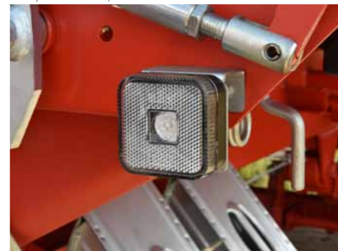
Instalacja oświetlenia z lampami LED
