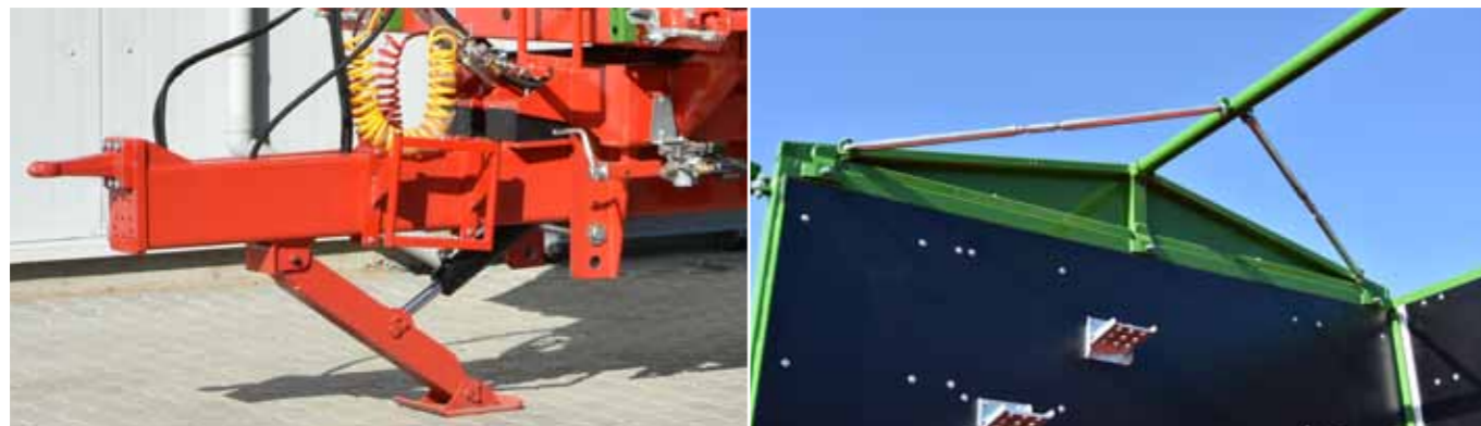
Dyszel uniwersalny sztywny do łączenia z dolnym lub górnym zaczepem ciągnika, amortyzowany resorami gumowymi
