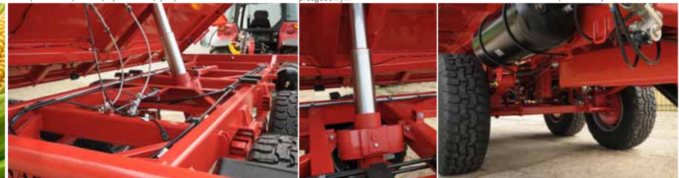
Rama podwozia z prostokątnych zamkniętych profili
