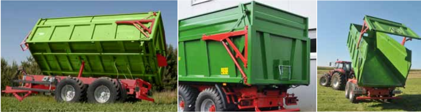
Wywrot na prawą stronę pod kątem 45° w T669/1
