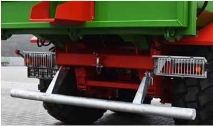
Tylne lampy oświetleniowe z kratkami zabezpieczającymi przed uszkodzeniem
