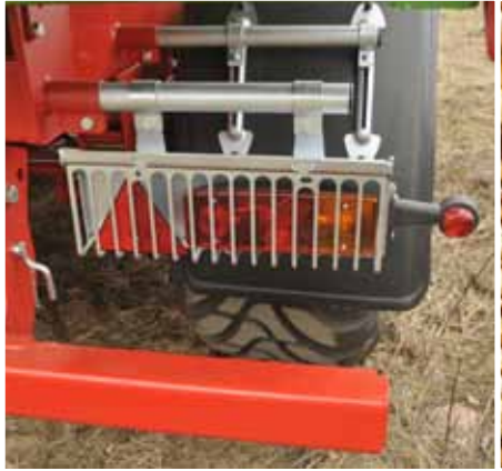
Tylne oświetlenie przyczepy jest zabezpieczone przed uszkodzeniami specjalnymi kratkami
