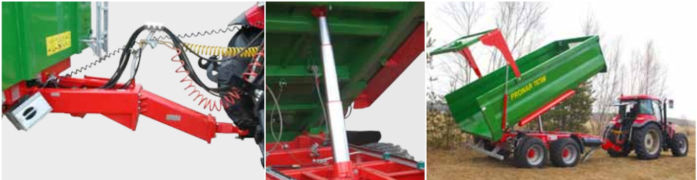
Uniwersalny dyszel umożliwiający łączenie z dolnym lub górnym zaczepem transportowym ciągnika Teleskopowy siłownik wywrotu skrzyni ładunkowej z zawiesiem przegubowym Skrzynia ładunkowa o budowie skorupowej z profilowanymi ścianami ze wzmocnionym obrzeżem górnym (T679M)
