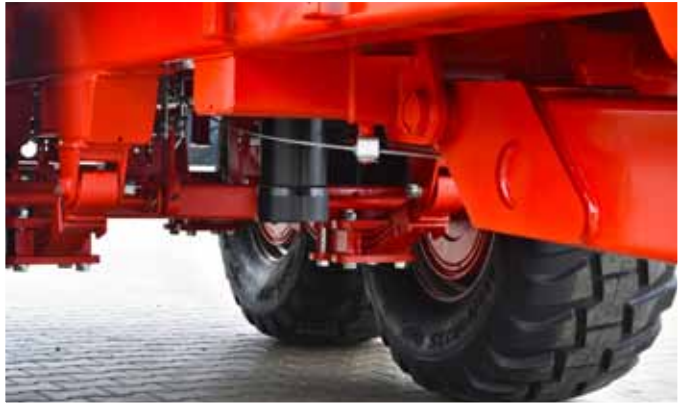
Zawieszenie tandem na resorach parabolicznych
