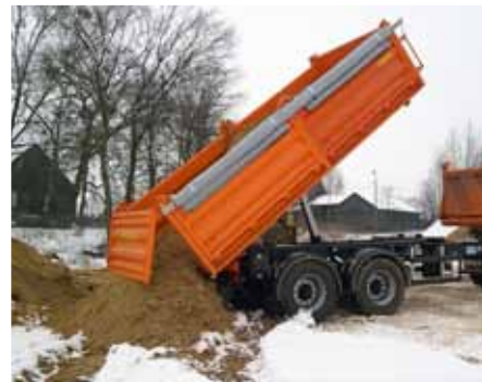
PC2100 - rozładunek przyczepy. Burta tylna uchylna otwierana automatycznie w momencie wywrotu.
