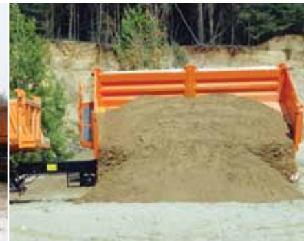
PC2100/1 - rozładunek przyczepy. Burta boczna lewa otwierana i zamykana za pomocą siłowników hydraulicznych
