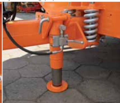
Amortyzowany mechanicznie dyszel i hydrauliczna noga podporowa
