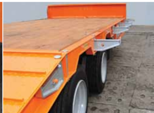
System poszerzenia powierzchni ładunkowej
