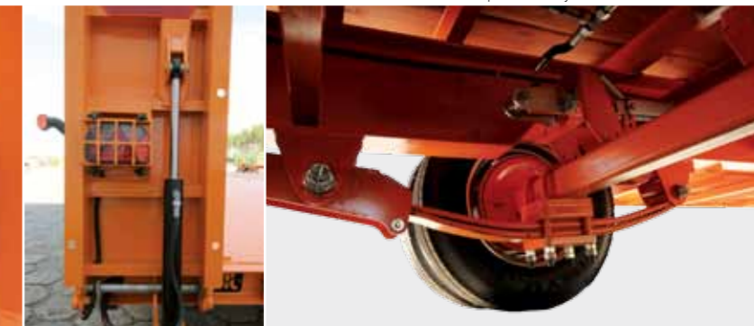
Zawieszenie tandem na resorach parabolicznych
