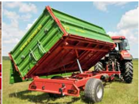
System wywrotu trzystronnego skrzyni z przegubami kulowymi tylnymi o optymalnym rozstawie
