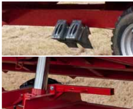
Kliny pod koła z kieszeniami w wyposażeniu standardowym i podpora serwisowa skrzyni ładunkowej
