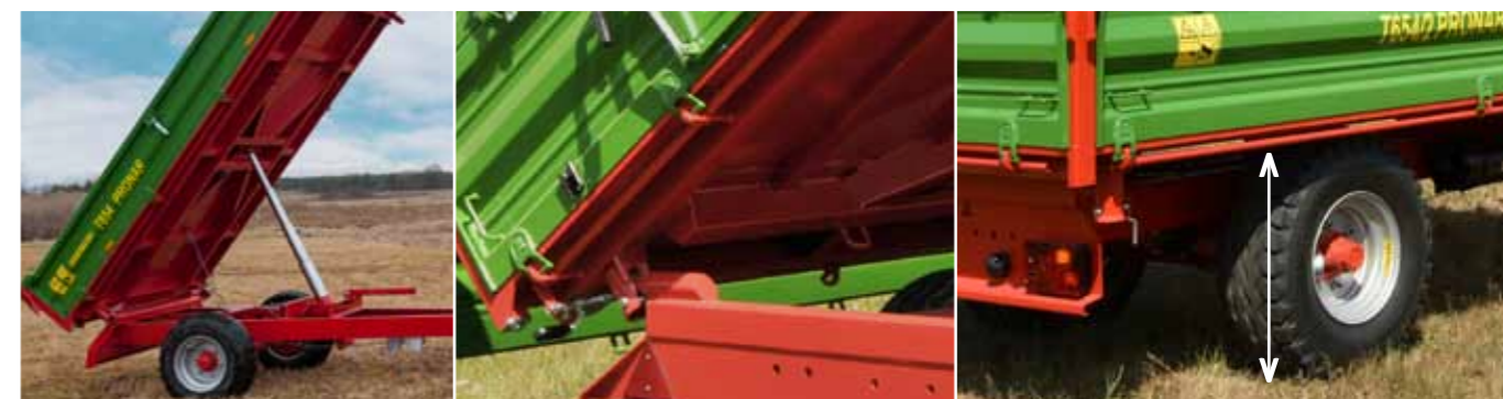
System wywrótu trójstronnego z silownikiem teleskopowym, z zawieszem przegubowym
