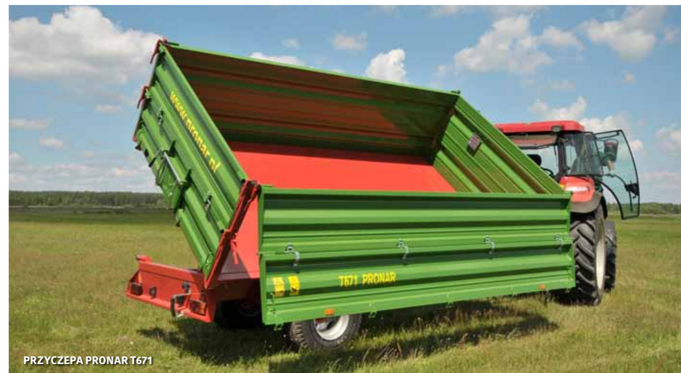
System wywrótu trójstronnego z silownikiem teleskopowym, z zawieszem przegubowym
