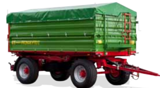
Skrzynia ładunkowa przystosowana do transportu europalet, ze wzmocnioną płytą podłogową
