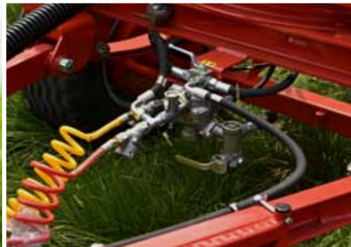
Dwuprzewodowa, pneumatyczna instalacja hamulcowa z ręcznym regulatorem siły hamowania
