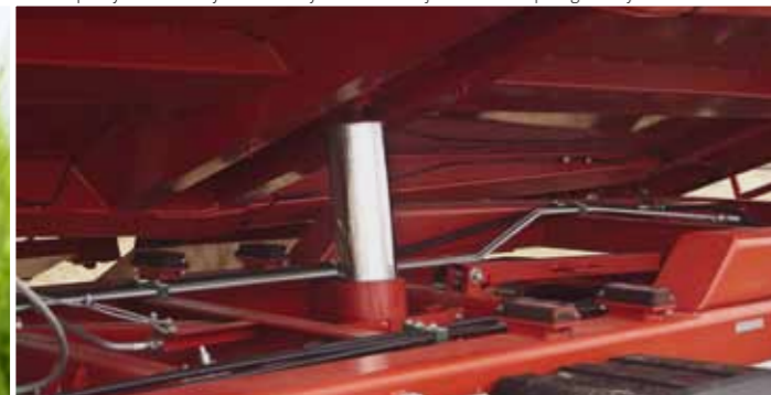
Teleskopowy siłownik wywrótu skrzyni ładunkowej z zawiesiem przegubowym
