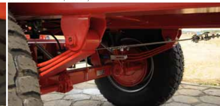
Solidne osie na resorach parabolicznych
