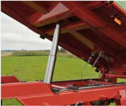
Rama podwozia spawana z prostokątnych zmkniętych profili ze stali konstrukcyjnej o wysokiej wytrzymałości
