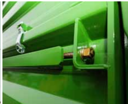
Listwowe wzmocnienie burt ścian bocznych
