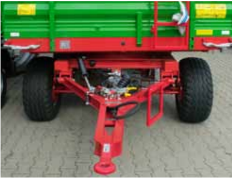
Dyszel typu Y z okiem 40mm
