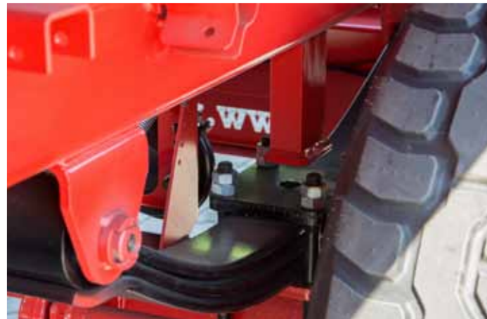
Zawieszenie na resorach parabolicznych z odbojnikiem stalowym
