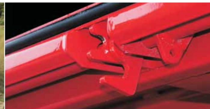
Solidny system ryglowania ścian przy podłodze
