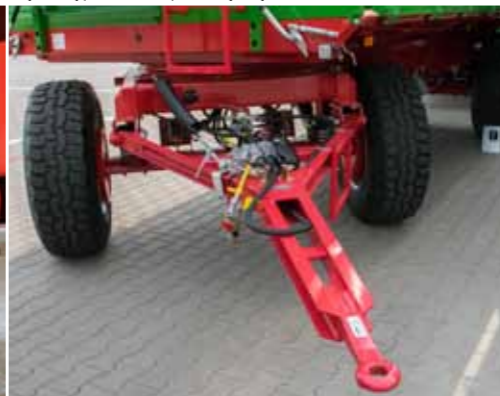
Dyszel typu Y z zaczepem sztywnym z okiem Ø40mm
