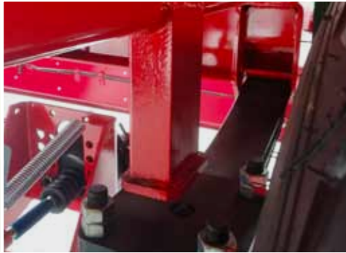
Zawieszenie na resorach parabolicznych z odbojnikiem stalowym
