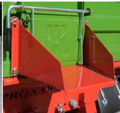
Szyber zsykowy do ziarna, z blokadą, w ścianie tylnej
