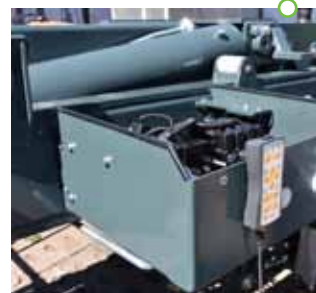
Centralny układ hydrauliczny sterowany elektrycznie
