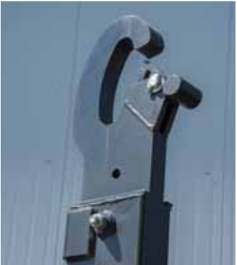
Hak z automatycznym zabezpieczeniem kontenera
