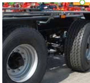
Zawieszenie z tylną osią skrętną kierowaną biernie
