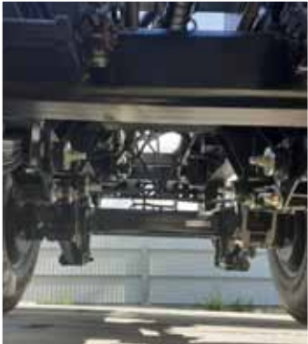
Zawieszenie typu tandem na 4 resorach parabolicznych
