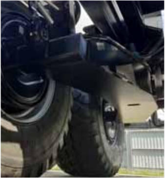
Zawieszenie tandem sztywne typu boogie
