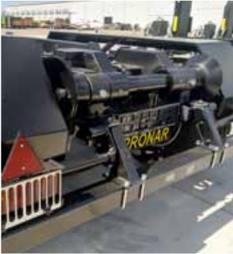
T185 - Zderzak tylny wysuwany bez światła
