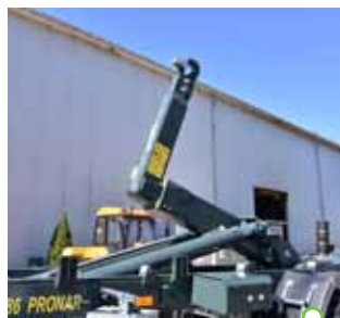
Podnoszenie realizowane dwoma siłownikami hydraulicznymi
