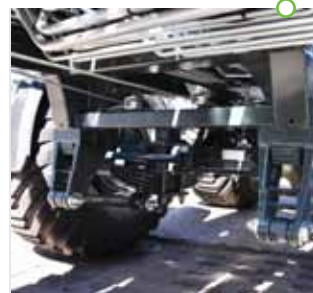
Zawieszenie tandem na resorach parabolicznych
