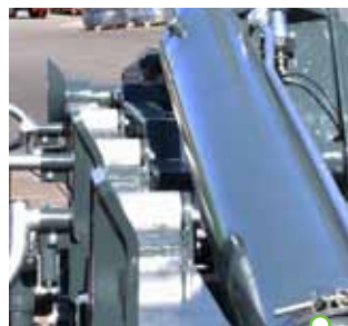
Rama podwozia o wysokiej wytrzymałości z rolkami podpierającymi kontener
