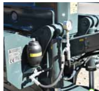
Dyszel amortyzowany hydraulicznie
