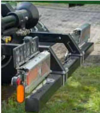
Zderzak tylny wysuwany ze światłami
