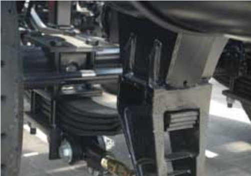
Oś przednia sztywna, oś tylna skrętna pasywnie z instalacją hydrauliczną blokady skrętu
