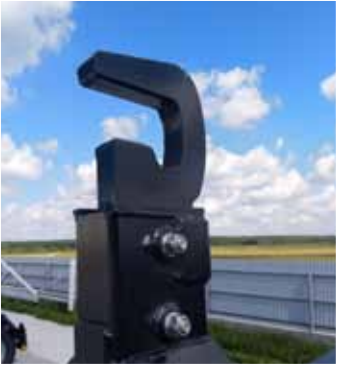
Hak bez zabezpieczenia kontenera
