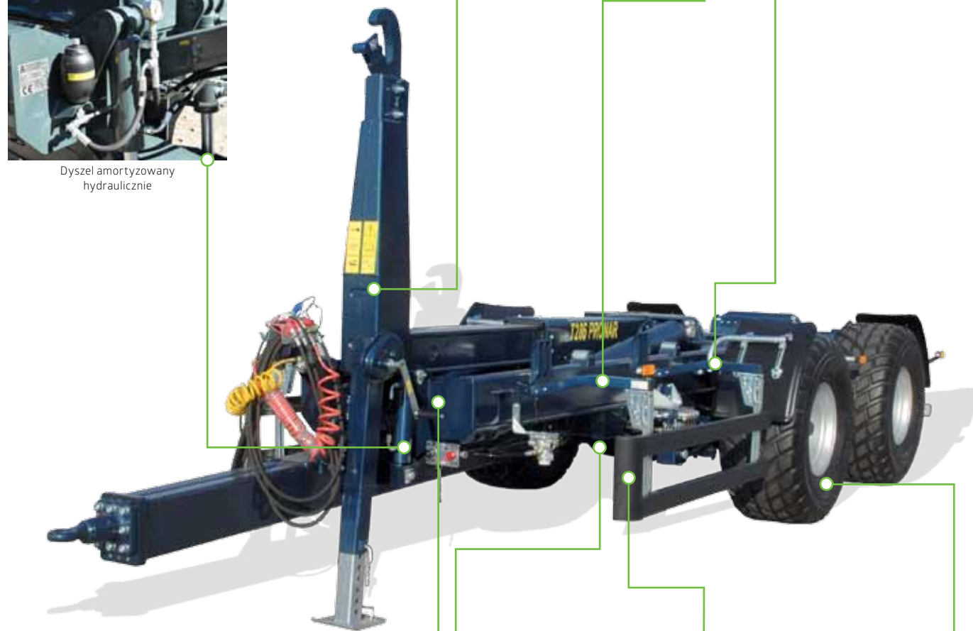
Rama podwozia o wysokiej wytrzymałości z rolkami podpierającymi kontener
