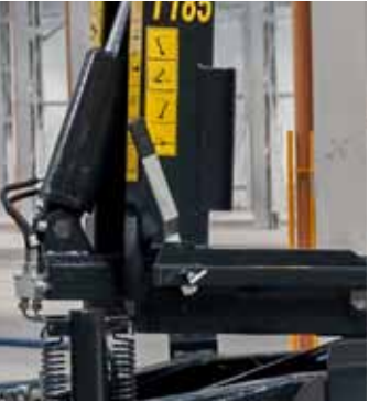
Manualne przełączenie funkcji hakowiec-wywrotka
