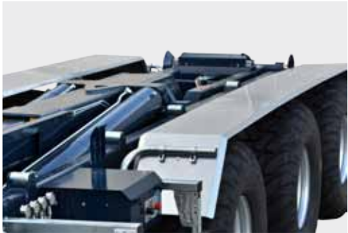
Stabilna rama z dwoma siłownikami hydraulicznymi
