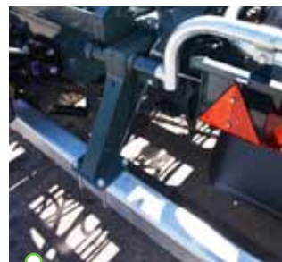
Zderzak tylny wysuwany hydraulicznie
