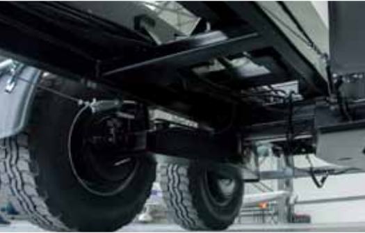
Zawieszenie tandem sztywne typu boogie
