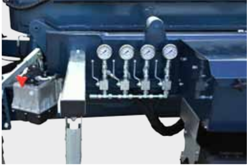
Układ hydrauliczny kierowania czynnego
