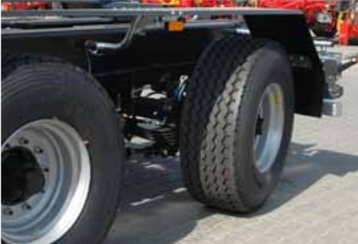
Zawieszenie typu tandem na 4 resorach parabolicznych
