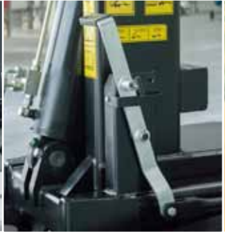
Manualne przełączenie funkcji hakowiec-wywrotka
