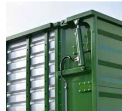
Ściana tylna podnoszona hydraulicznie, skrzynia przystosowana do montażu walców dozujących z napędem
