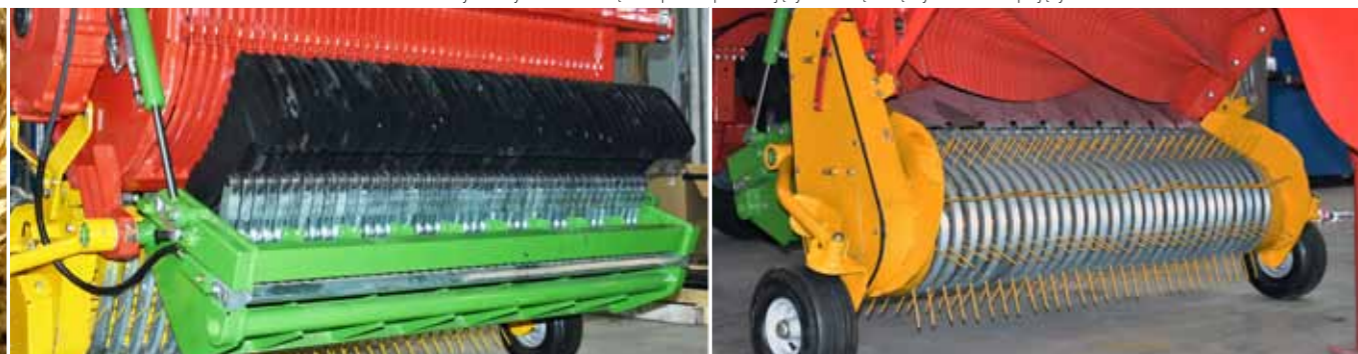
Podbieracz krzywkowy z ośmioma rzędami palców podbierających z rolką i skrętnymi kołami kopiującymi
