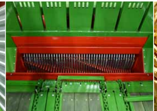
Rotor załadunkowy z trudnościelnej blachy
