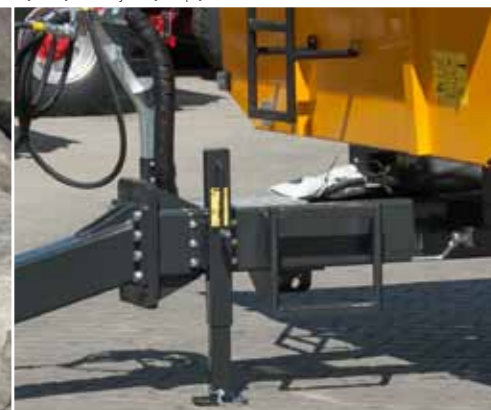
Mechaniczna teleskopowa podpora dyszla, z przekładnią kątową, ze sztywną stopą
